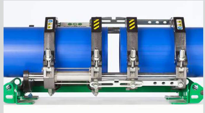
Ecarter les tubes et retirer le miroir chauffant
