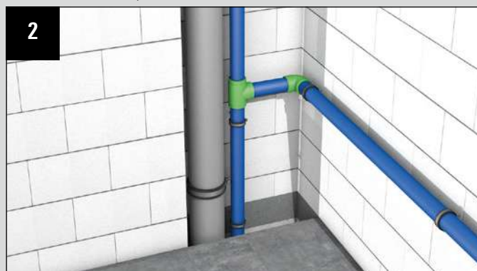
Positionnement favorable de la colonne montante en vide technique
