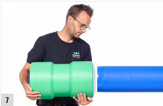
7 Positionner le manchon coulissant sur l'extrémité du tube et le pousser au-delà du premier joint.
