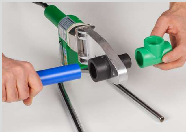
Chauffage des éléments
