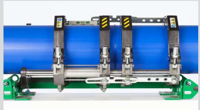
Assembler les tubes et laisser refroidir en maintenant la pression
