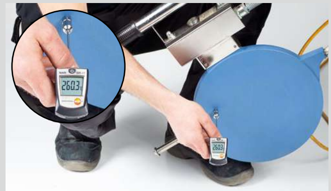
Mesure de la température sur la machine de soudage bout à bout aquatherm
