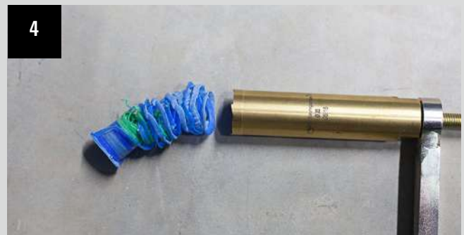
Retirer les résidus de perçage de l'outil d'alésage
