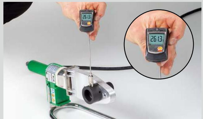
Mesure de la température sur l'appareil de soudage manuel aquatherm (800 W)
