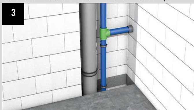
Fourreau largement dimensionné en traversée murale
