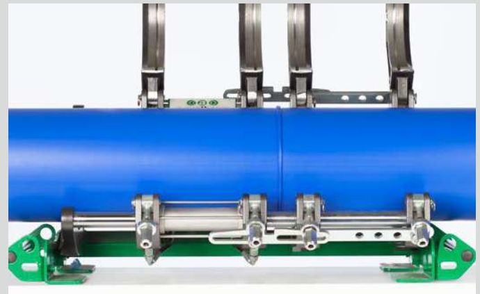
Relâcher la pression et dégager l'ensemble
