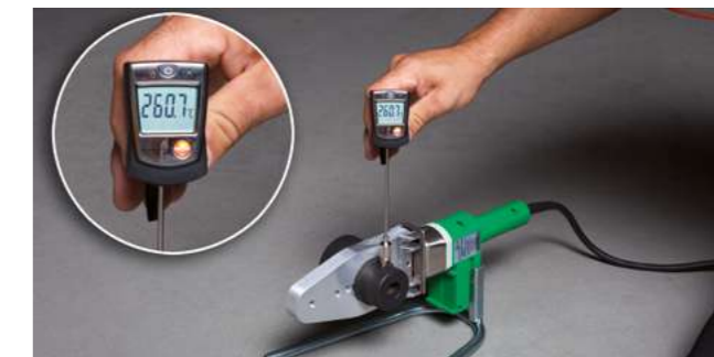
Mesure de la température avec l'appareil de soudage manuel aquatherm (800 W).
