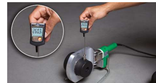
Thermorégulation de l'appareil de soudage aquatherm (1400 W)
