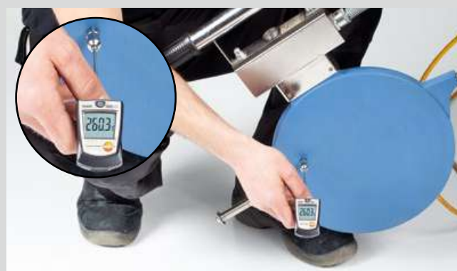
Mesure de la température sur la machine de soudage bout à bout aquatherm
