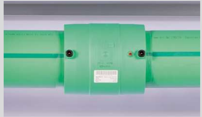
Introduire les extrémités de tube ébarbés, parfaitement coupés et nettoyés
