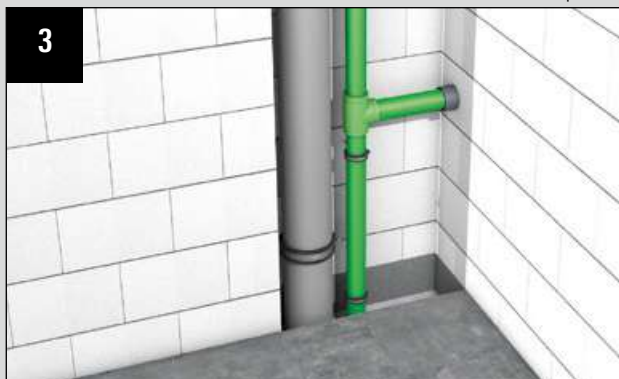
Fourreau largement dimensionné en traversée murale
