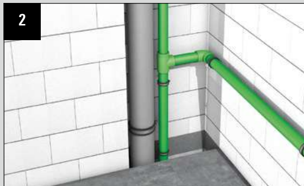
Positionnement favorable de la colonne montante en vide technique
