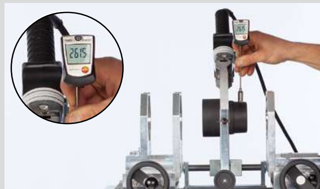
Mesure de la température sur la machine de soudage aquatherm
