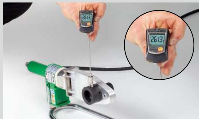
Mesure de la température sur l'appareil de soudage manuel aquatherm (800 W)
