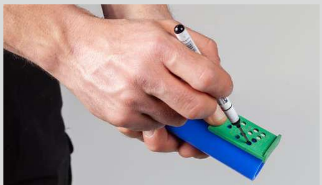
Traçage de la profondeur d'emboîtement
