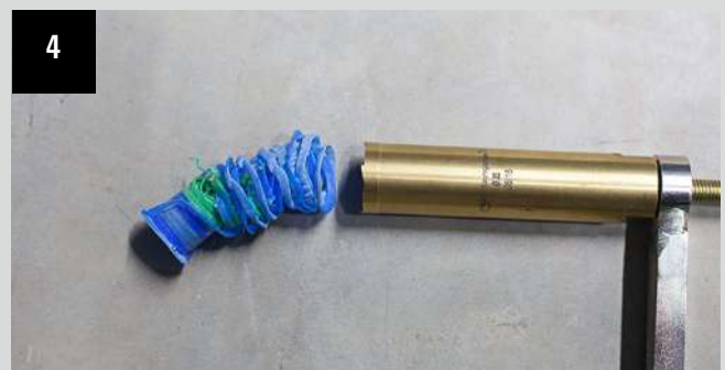
Retirer les résidus de perçage de l'outil d'alésage
