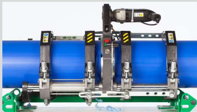
Guider et fixer les éléments a assembler et insérer le robot
