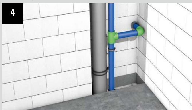
Réalisation d'un bras d'absorption
